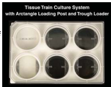
图5. 带有尼龙网锚 TissueTrain 细胞培养板, 三维细胞组织培养模具, 弧矩形加载平台 (Arcangle Loading post.)
